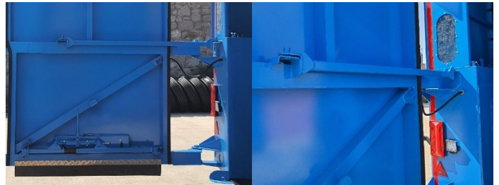
Resim28. 90° kapı açılımı ve üst kol ile sabitleme
