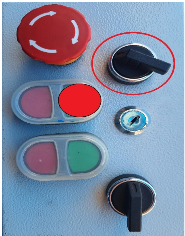
Resim 15. Yük tutma kolları şalteri manuel konum ve kol açma butonu
