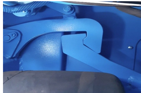
Resim 36. Dingil kaldırmak için kilit dilinin dingile kilitlenmesi.
