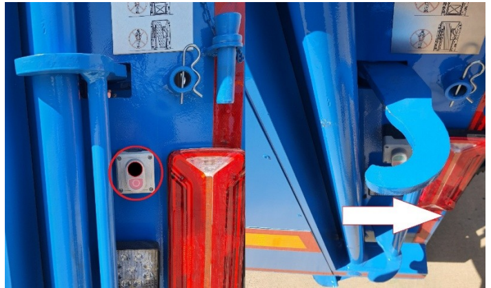
Resim 14. Kapı açma butonu ve kapı tutma kolları
