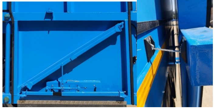
Resim26. 270° kapı açılımı destek kolları kapı üzeri konumları
